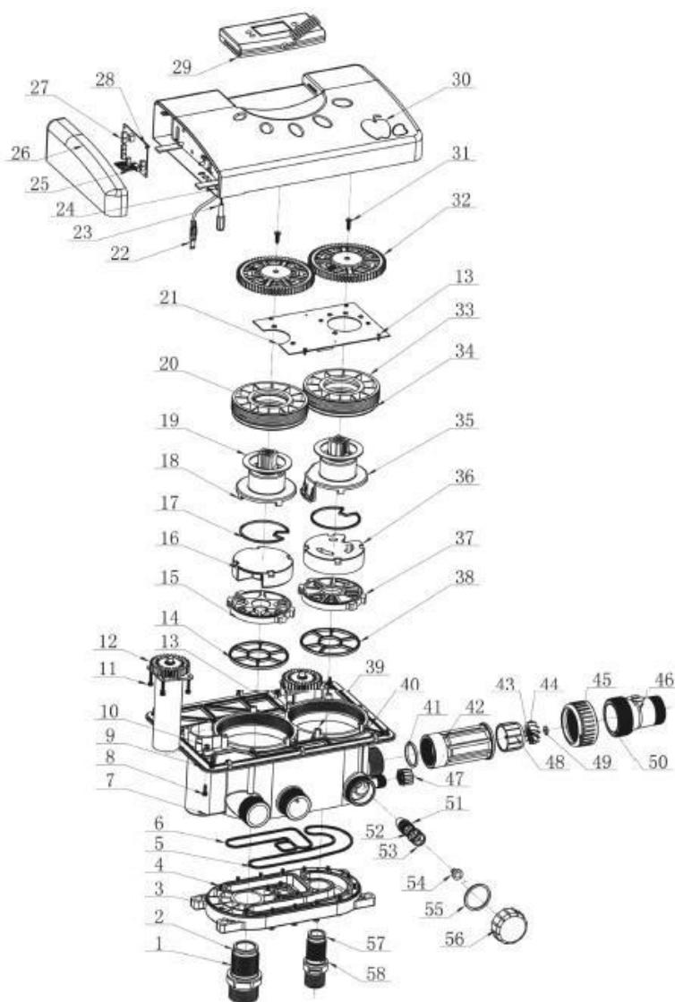
**Номера деталей клапана F88A/F88C**
