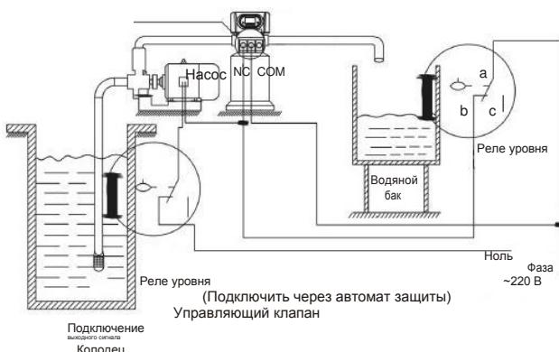
Рисунок 3-5. Подключение регулятора уровня для управления входным насосом
